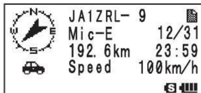
Пример дисплея трансивера при приеме APRS сигнала
