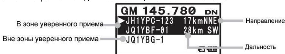
Пример дисплея трансивера при выборе значения ALL
