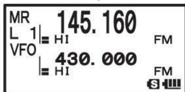
Нижняя частотная граница в канале L1
