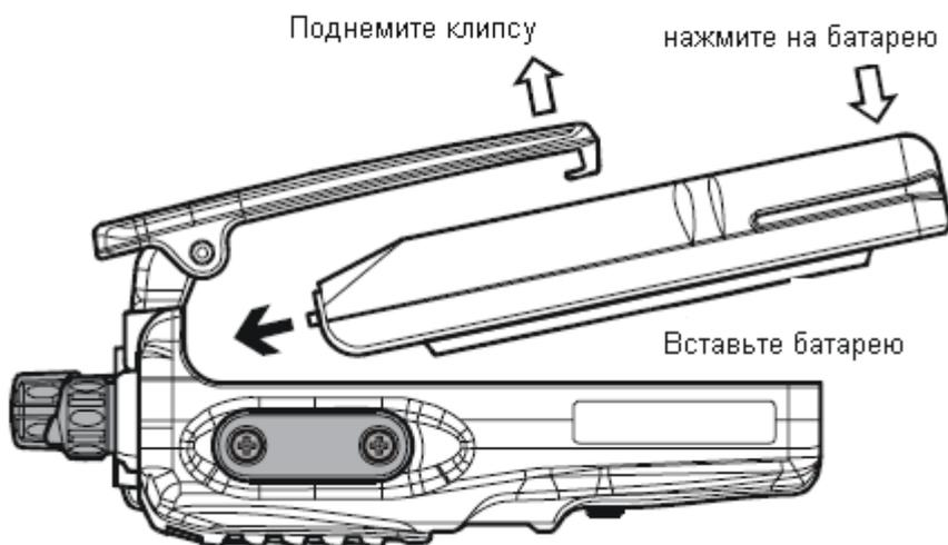
■ Для удаления батареи, выключите радиостанцию и снимите защитный чехол. Откройте замок батареи, затем нажмите на верхнюю часть клипсы, поднимите нижнюю часть батареи и удалите ее из радиостанции.
